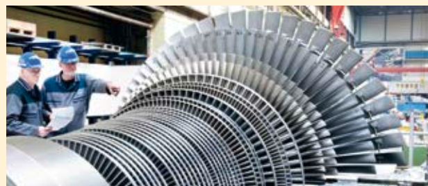
Abb. 3 Eine einhäusige Industrie-Dampfturbine zur Stromerzeugung mit einer Leistung von 80 MW
